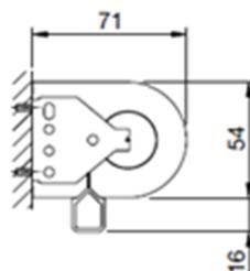
Coupe de principe pose de face
