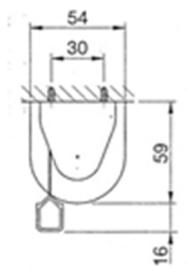
Coupe de principe pose de face
