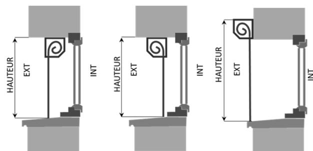
(1) Pose tableau Enroulement intérieur (2) Pose tableau Enroulement extérieur (3) Pose de face Enroulement extérieur
