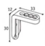
Equerre cristal pour guidage par câbles
